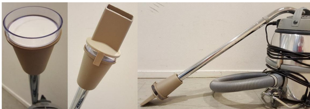
Figur 1: Montering av adapter og filterholder på støvsuger.
